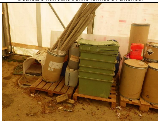
Stockage de déchets type ancre et autre sous le chapiteau sans bac de rétention pour les déchets liquide
