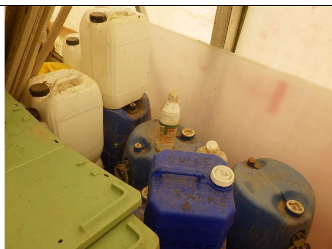
Stockage de déchets type encre et autre sous le chapiteau sans bac de rétention pour les déchets liquide
